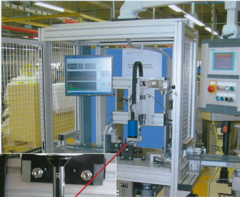
Bild 3. Rattermarkenmessautomat: 100-Prozent-Messung von Nadellager- Außenringen. Der Ausschnitt zeigt einen Optikadapter für die Bohrungsmessung.
